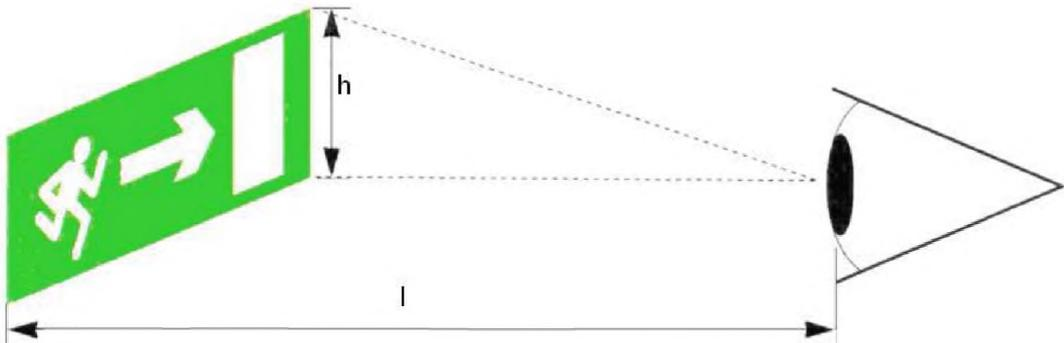
Рисунок 2 – Определение расстояния различения эвакуационного знака безопасности
